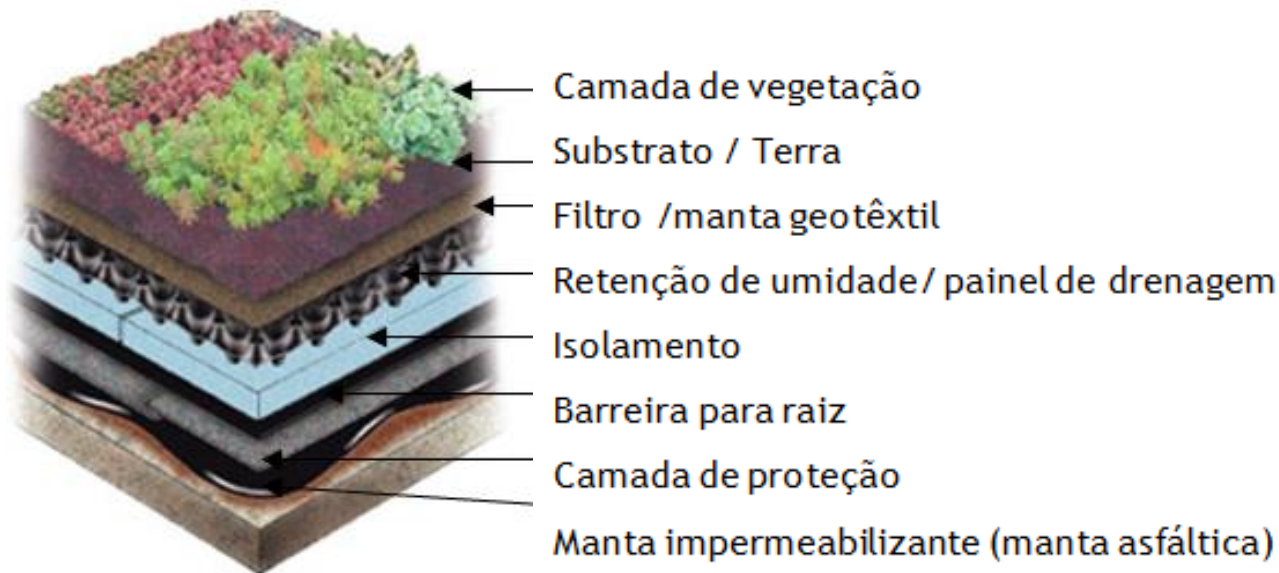
Esquema geral de uma cobertura verde
